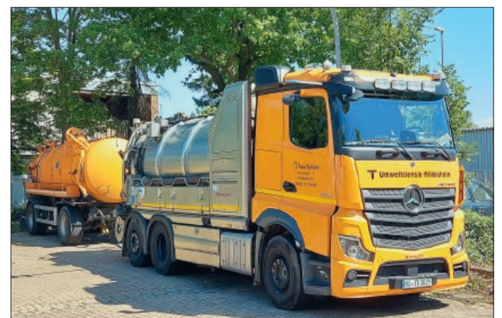
Dieses Fahrzeug kommt für die Reinigung und Entsorgung von Fettabscheidern zum Einsatz.
