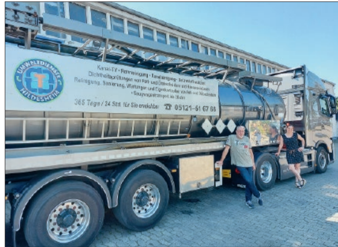
Besonders stolz sind Hans-Jörg und Jennifer Thon über das Saug-Druck-Tankfahrzeug mit einem Gesamtvolumen von 26 Kubikmeter.
