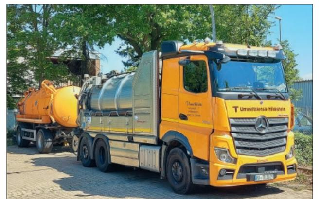
Dieses Fahrzeug kommt für die Reinigung und Entsorgung von Fettabscheidern zum Einsatz.
